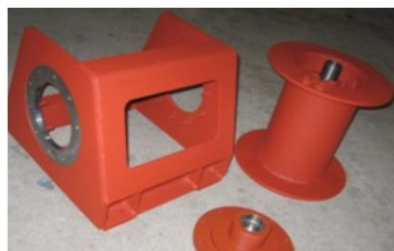
Dele til kranspil Overfladebehandling – shopprimer
