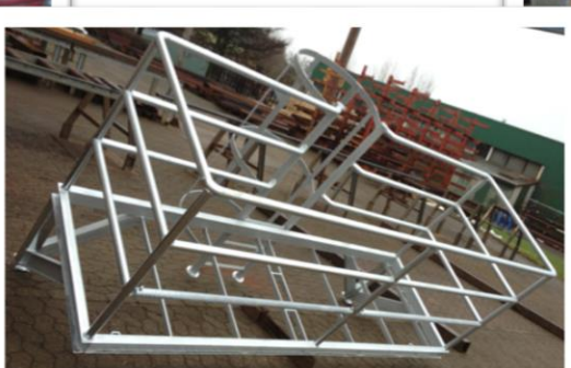
Platform til tank på rig Overfladebehandling – Galvaniseret
